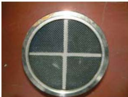
Fig 9. Udløbssiden af et brugt filter
