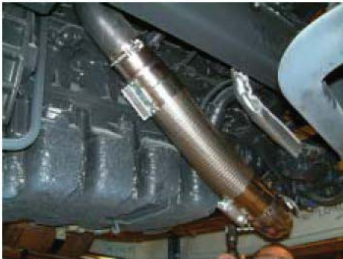
Fig. 6 – Typisk flexibel slange på udstødning
